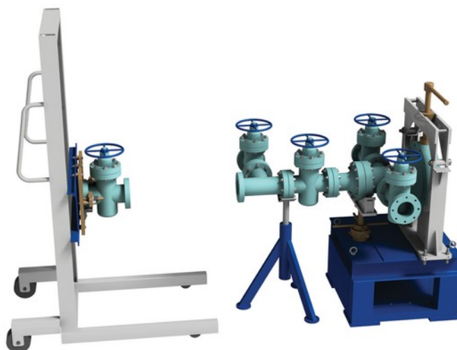
Рабочее место для разборки-сборки фонтанной и нагнетательной арматуры
