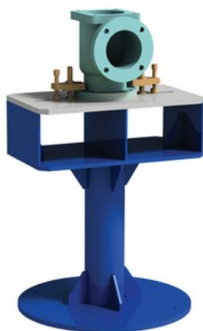
Установочное приспособление для разборки-сборки предохранительных клапанов
