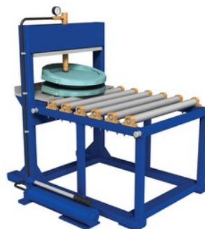
Установочное приспособление для разборки-сборки клина
